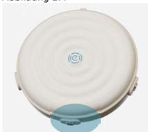
➤ **Hinweis** Durch ein kurzes Drücken wird Ihr Gerät eingeschaltet, durch ein langes Drücken schaltet sich Ihr Gerät aus.
